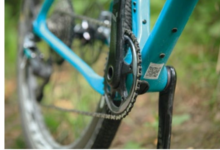
Der vordere Umwerfer fällt weg: Einfachschaltssysteme setzen sich auch bei vielen Offroad-Rennern durch.
